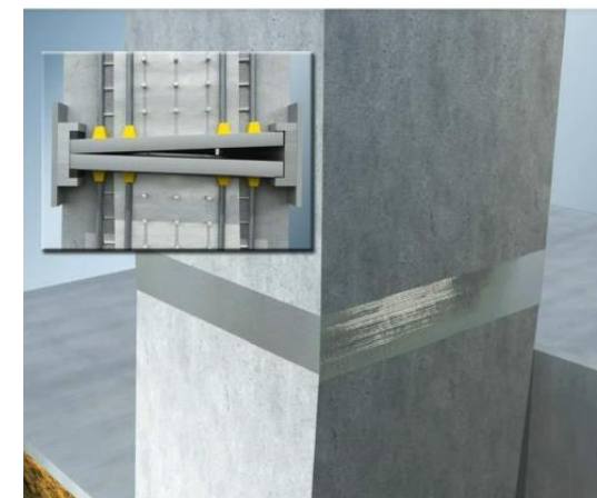
圖 10-3 卸震鋼甲施作示意圖
